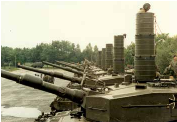
Teile des Panzerbataillons 34 bereiten sich auf die Tiefwat-Ausbildung vor. Über zwei Meter tiefe Gewässer konnte der Kampfpanzer Leopard 1 durchfahren.
